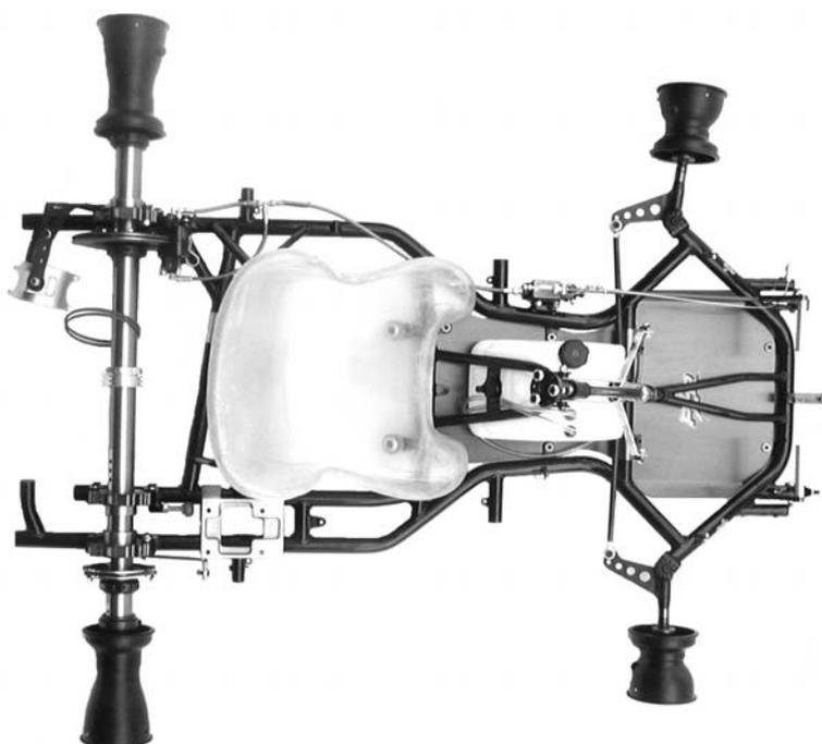
PHOTO VUE DE DESSUS DU CHÂSSIS COMPLET IDENTIQUE À L'UN DES MODÈLES PRÉSENTÉS À L'HOMOLOGATION SANS PARE-CHOC, CARROSSERIE NI PNEUMATIQUES
