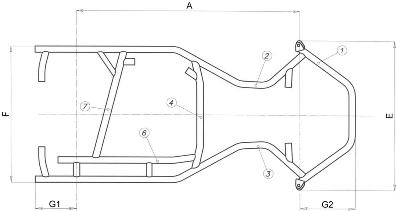
Représenter seulement les tubes principaux de la structure et les attaches supportant les fusées et les barres de rigidification nécessitant informations et dimensions à la section B
